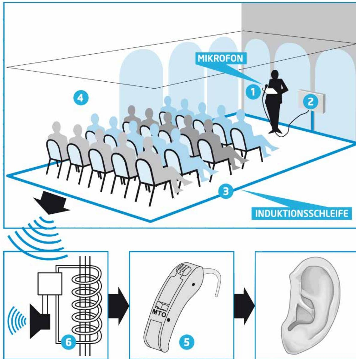
Anlage 1 Induktive Höranlage Funktionsschema
