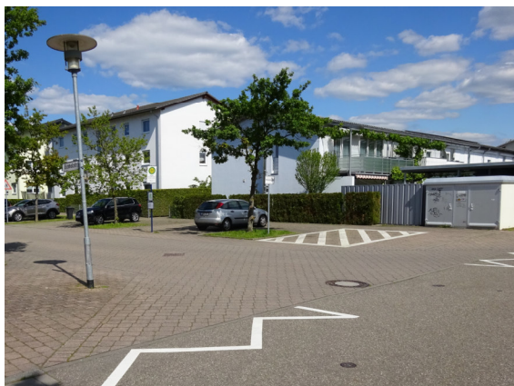
Abbildung 102: Einfahrtssituation Belagswechsel (l.); temporeduzierende Einbauten und Markierungen (r.)
