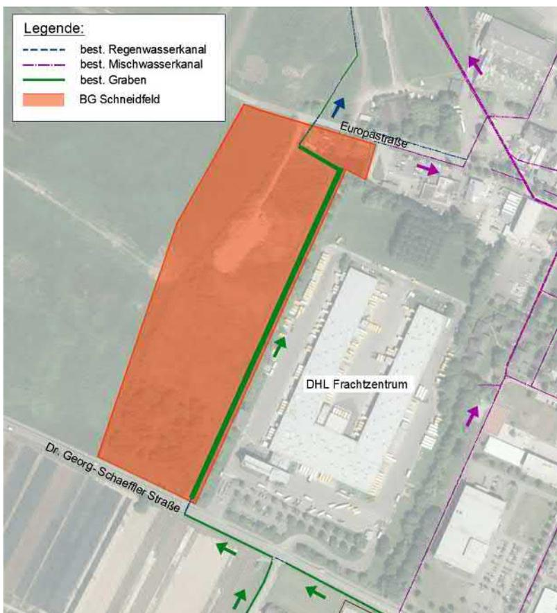
Abbildung 3.4: bestehende Entwässerung im Bereich des BG Schneidfeld
