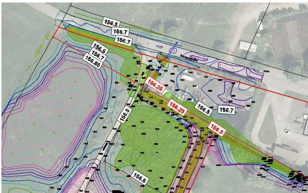
Abbildung 4.6: Retentionsfläche im Bereich des Flurstückes 9034. Die Flurstücksgrenzen sowie die minimal im Bereich des Flurstücks bzw. in der direkten Umgebung des Flurstücks aufgenommenen Geländehöhen sind rot dargestellt.
