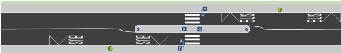
Abbildung 8: Skizze einer Haltestelle mit Querungshilfe für einen sicheren Fahrgastwechsel
