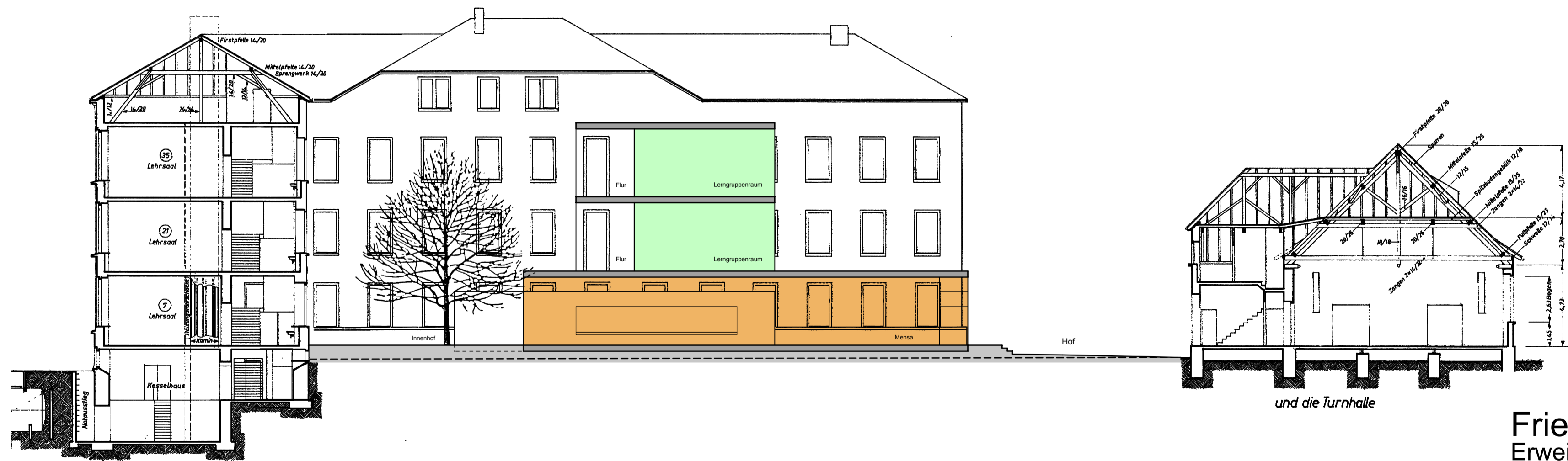
Schnitt C-D durch den Südflügel im Kesselhausbereich
