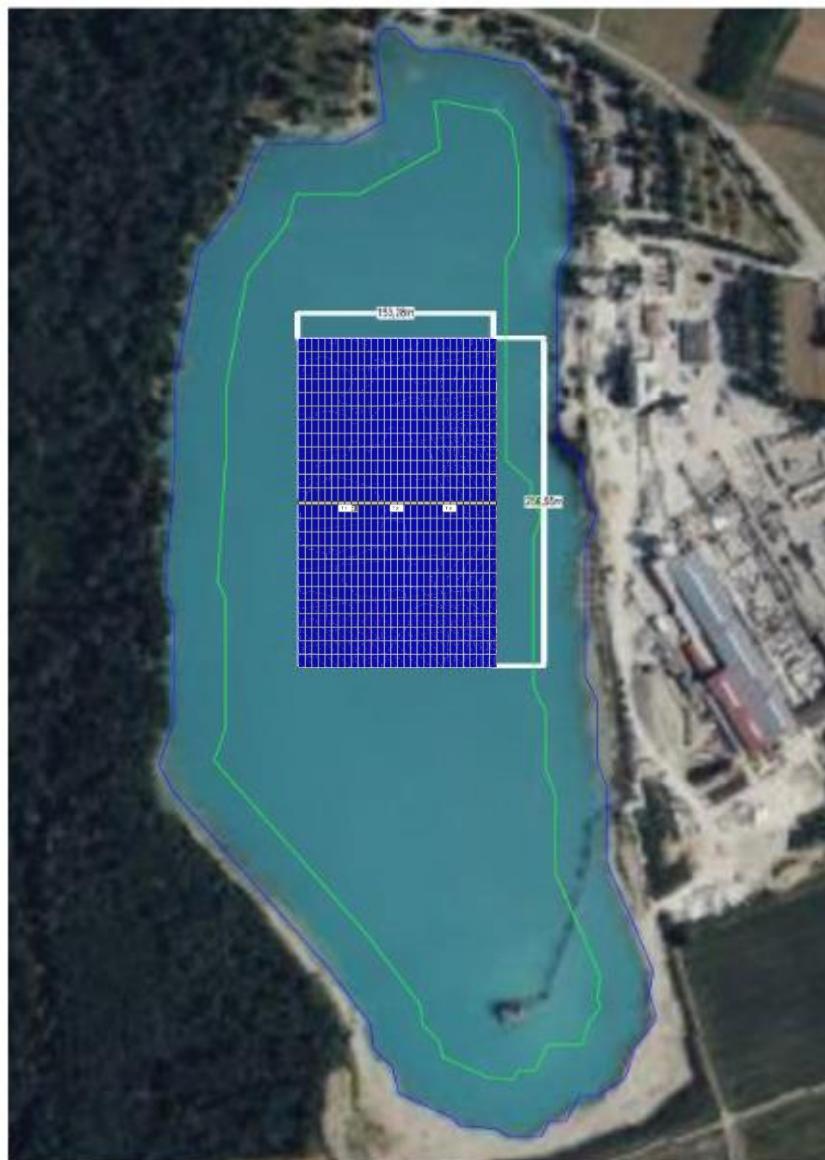
Abbildung 2: Draufsicht des Layouts der schwimmenden PV Anlage Kippenheimweiler mit Gesamtabmessungen von 153,3 x 256,6 m
