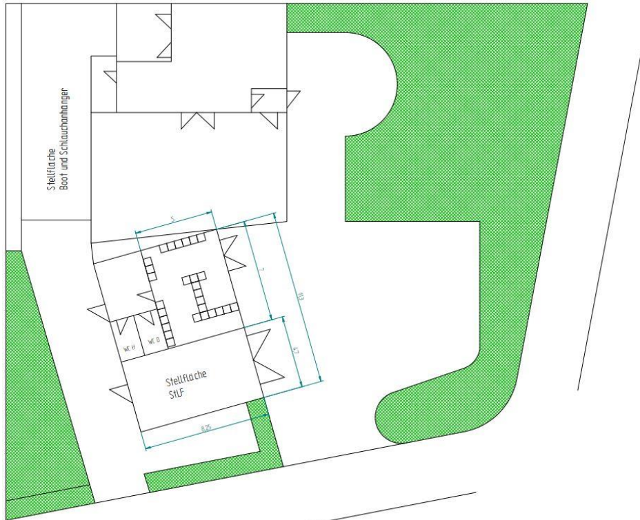
Abbildung 71: Erweiterungsvorschlag bestehendes Feuerwehrhaus
