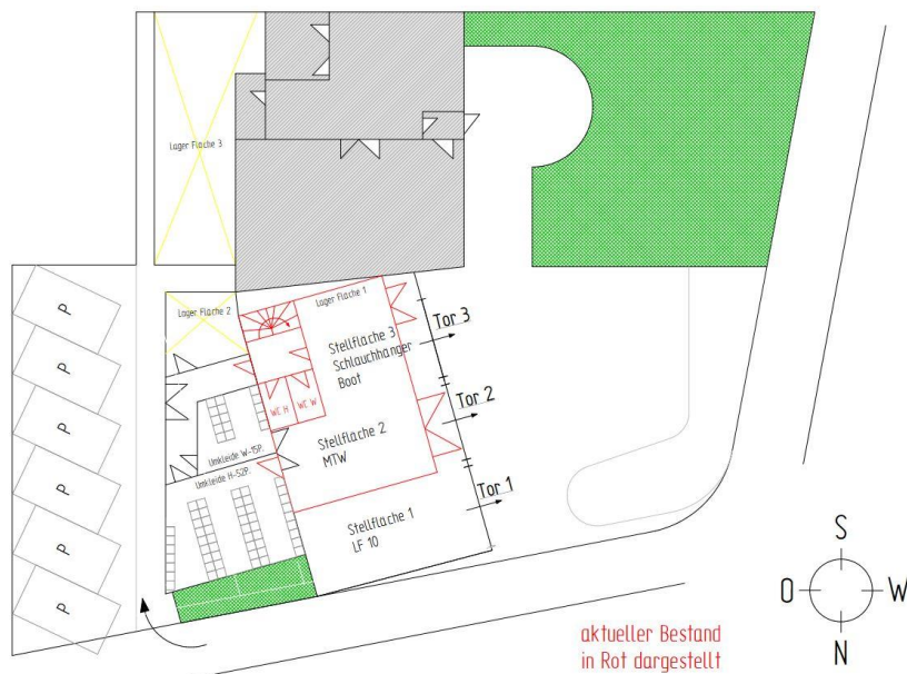
Abbildung 74: Erweiterungsvorschlag bestehendes Feuerwehrhaus
