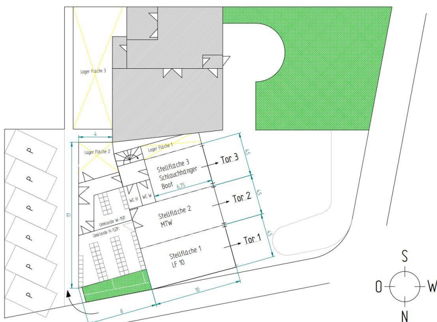
Abbildung 72: Erweiterungsvorschlag bestehendes Feuerwehrhaus
